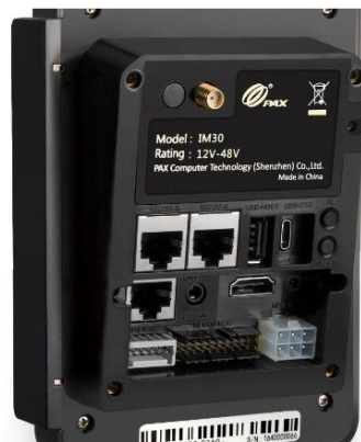
Zadnja strana PAX IM30 sa priključcima
