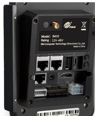
Face arrière du PAX IM30 et ses ports
