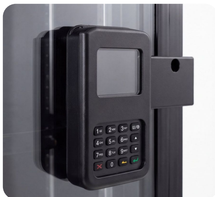
Τερματικό τοποθετημένο στην πόρτα του ψυγείου
